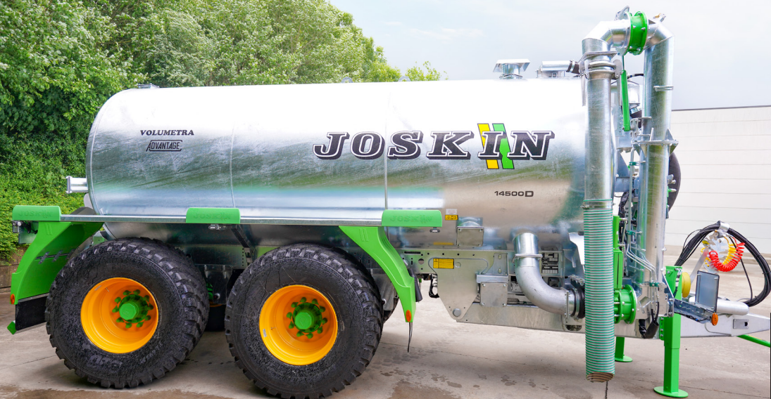
Essieu directionnel forcé et suspension hydraulique Hydro-Tandem
